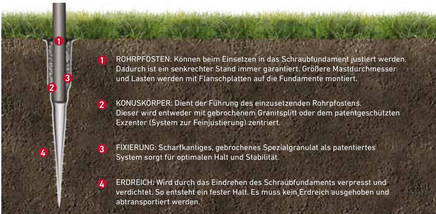
**1** ROHRPFOSTEN: Können beim Einsetzen in das Schraubfundament justiert werden. Dadurch ist ein senkrechter Stand immer garantiert. Größere Mastdurchmesser und Lasten werden mit Flanschplatten auf die Fundamente montiert.
