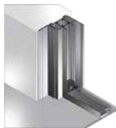
D: Montage en tunnel avec profil fin
