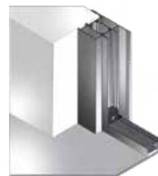
F: Montage tunnel avec cornière de finition extérieur
