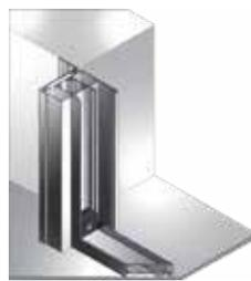
C: Montage hinter dem lichten Maß mit Montageprofil schmal
