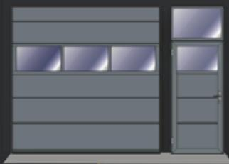
Gleiche Ansicht mit Sektionaltor mit verglaster Sektion
